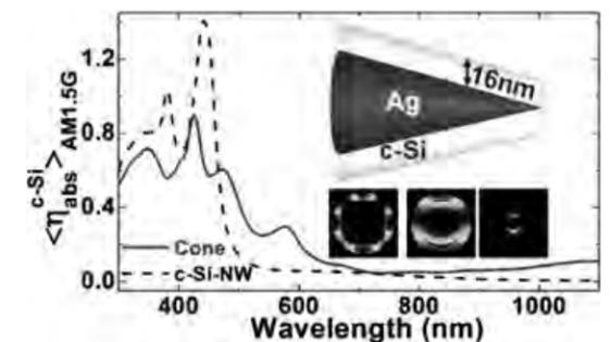
示给出了单晶硅 - 银纳米锥结构归一化的光吸收效率谱线。
